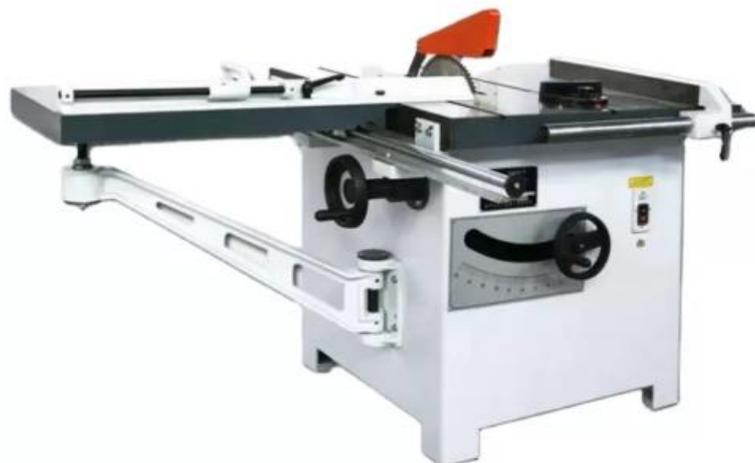
Станок предназначен для продольной, поперечной и под углом распиловки досок, брусков, древесных, плитных и листовых материалов. Широко применяется в столярных цехах и деревообрабатывающих производствах.
